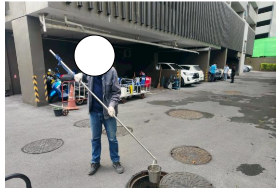
จุดระบายน้ำออกจากระบบบำบัดน้ำเสีย
